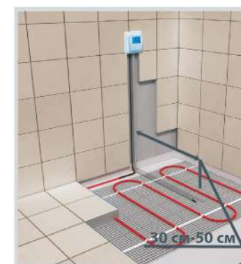
Схема укладки датчика температуры в гофрированной трубке
